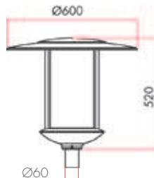
• POIDS SANS APPAREILLAGE/SURFACE SCX : 7,3kg/0,07 m<sup>2</sup>
